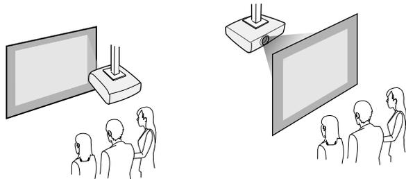
Wählen Sie die entsprechend der verwendeten Installationsmethode richtige **Projektion**-Option im Projektormenü **Installation**. Schalten Sie bei Bedarf die Einstellung **Taste Richtgsumkehr** im Projektormenü **Betrieb** ein.
