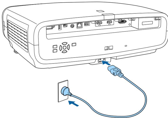
Der Projektor ruft den Bereitschaftsmodus auf. Dies zeigt an, dass der Projektor mit Strom versorgt wird, aber noch nicht eingeschaltet ist.
