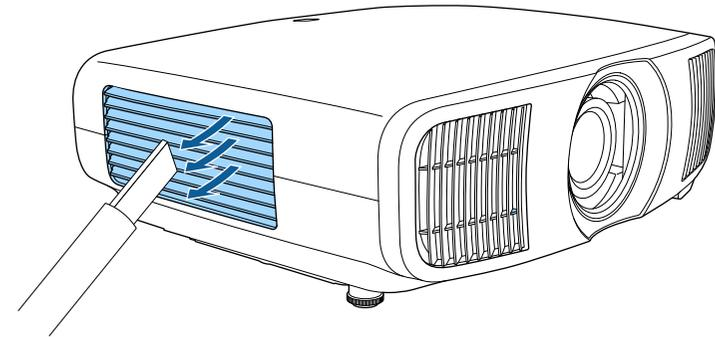
**3** Lösen Sie die Schrauben und entfernen Sie die Luftfilterabdeckung.
