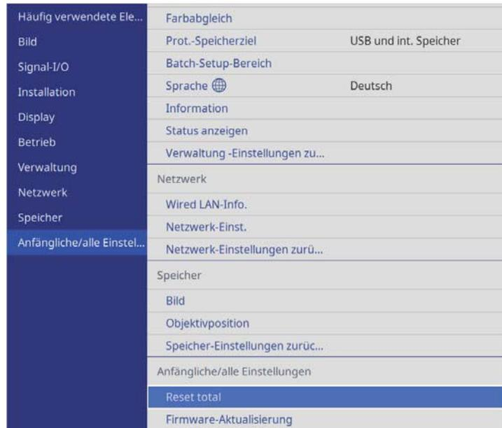
Alle Anzeigen des Projektors beginnen zu blinken und die Firmware-Aktualisierung startet. Wenn die Aktualisierung normal abgeschlossen wird, ruft der Projektor den Bereitschaftsmodus auf (nur die Betriebsanzeige leuchtet blau). Falls Einstellung **Direkt Einschalten** im Projektormenü **Betrieb** auf **Ein** gesetzt ist, schaltet sich der Projektor wieder ein.
