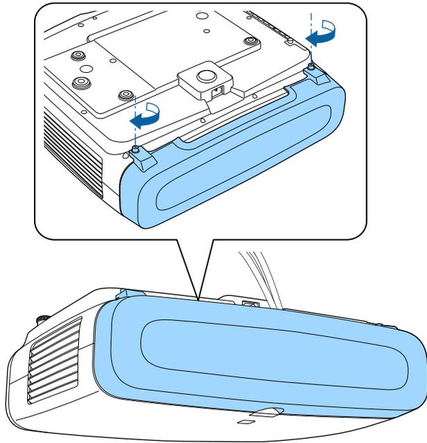
Entfernen Sie die Abdeckung, indem Sie die Abdeckungsschrauben lösen und die Abdeckung vom Projektor abziehen.
